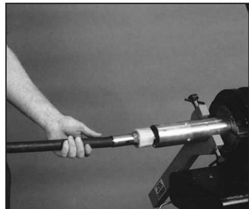
FIG. 40: REMOVE CONTROL STUD
