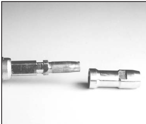
FIG. 43: REMOVE CONTROL STUD ADAPTER
